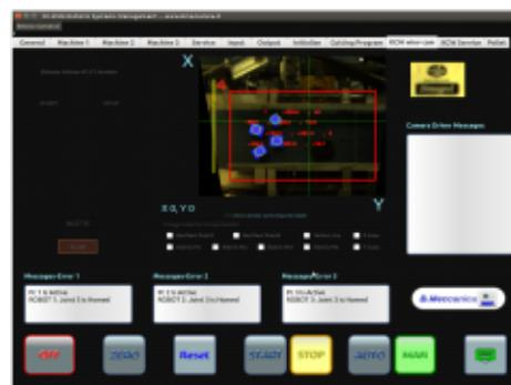
Una tastiera touch screen a scomparsa aiuterà l'operatore nel compito di ricerca e carico programmi dalla zona di memoria del sistema. Altri tasti di comando permettono le modalità di funzionamento diverse a diverse velocità scelte, come la modalità manuale e quella a passi per meglio visualizzare i singoli movimenti del robot (normalmente utilizzato in modalità manutenzione).
