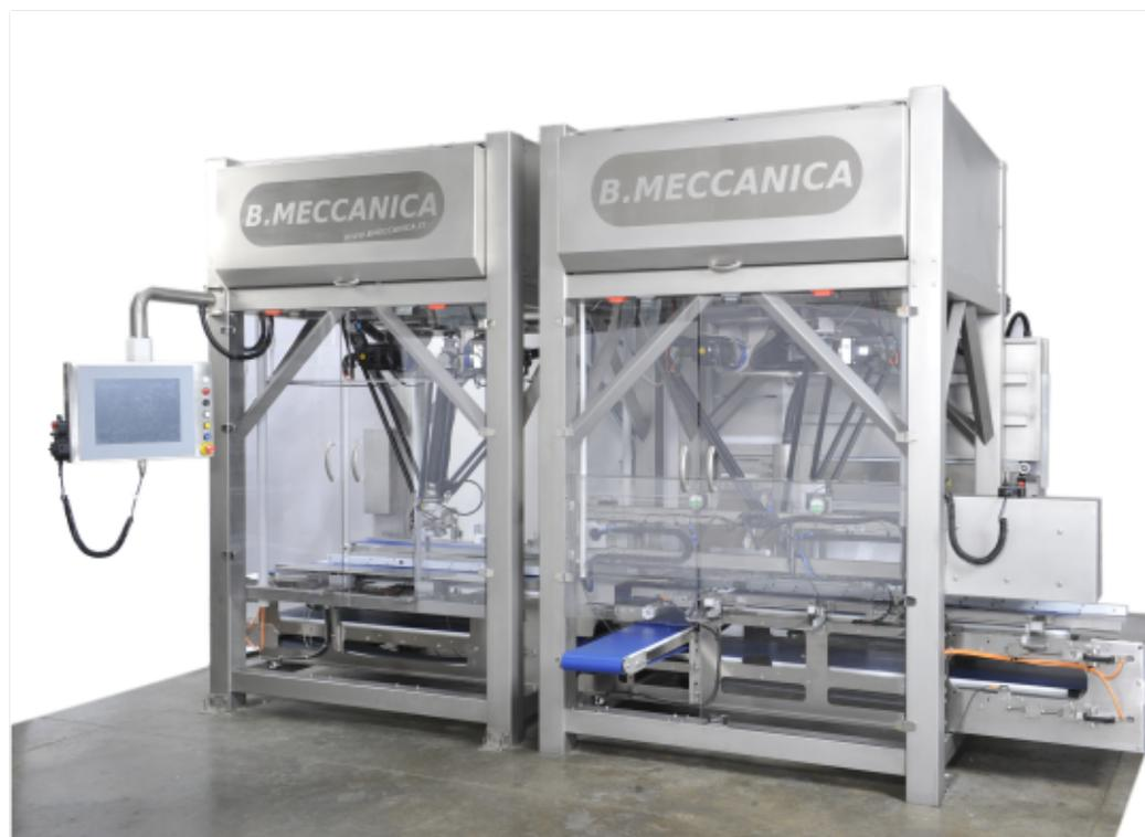
B.Meccanica ha realizzato una struttura Monoblocco, trasportabile, in acciaio inox AISI304, con Quadri Elettrici e Comandi Pneumatici sulla sommità per permettere ai dispositivi sottostanti di subire lavaggi anche gravosi tipici dei laboratori Alimentari.
